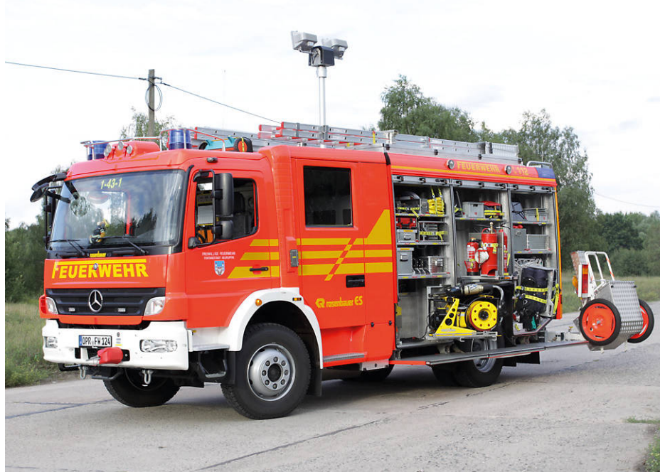
Beispielfoto eines Hilfeleistungslöschgruppenfahrzeug 20 (HLF 20), Baujahr 2010, vom Typ Mercedes Benz Atego 1326 AF mit Aufbau der Firma Rosenbauer Foto: Florian Schäffer
